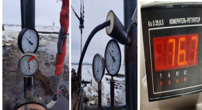
Рис. 5 Температура жидкости и давление до и после установки «Диплайн», показания реле измерителя-регулятора температуры масла в установке 31.03.22.
