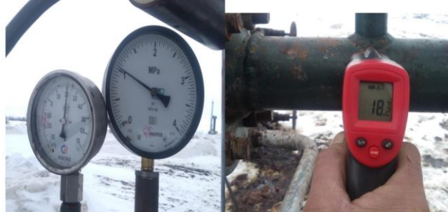
Рис. 4 Температура жидкости и давление на выходе установки «Диплайн» 29.03.22.
