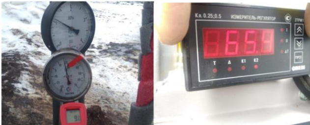
Рис. 3 Температура жидкости и давление на приеме установки «Диплайн» 29.03.22, показания реле измерителя-регулятора температуры масла в установке.
