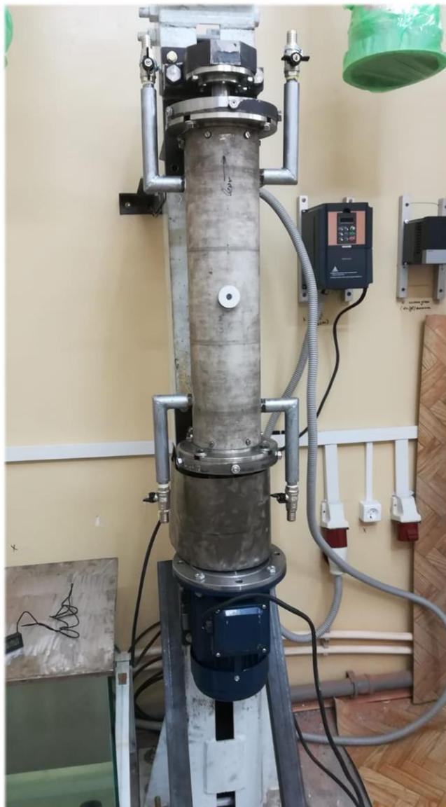
Схема стенда для исследования воздействия переменного электромагнитного поля низкой (от 0 до 200 Гц) и средней (от 200 до 2000 Гц) частоты на скважинную жидкость (нефть – вода – газ)
