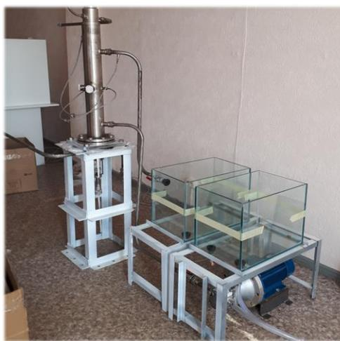
Схема стенда для исследования воздействия эффекта Юткина на скважинную жидкость (нефть – вода – газ)
